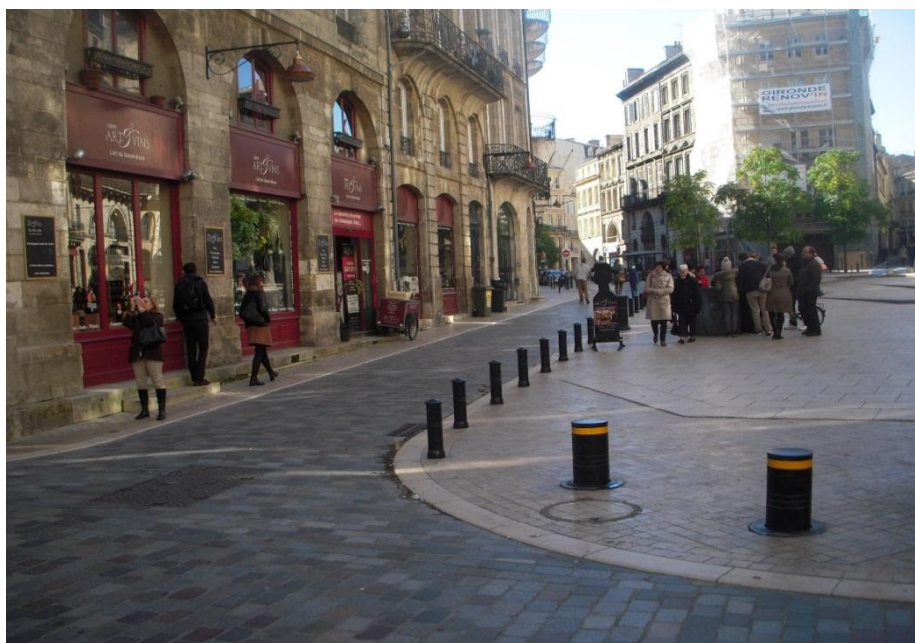
Figura XX- Burdeos. Pavimentación diferenciada en acera y calzada; bolardos fijos y escamoteables. Al fondo, maqueta táctil consultada por los visitantes.
